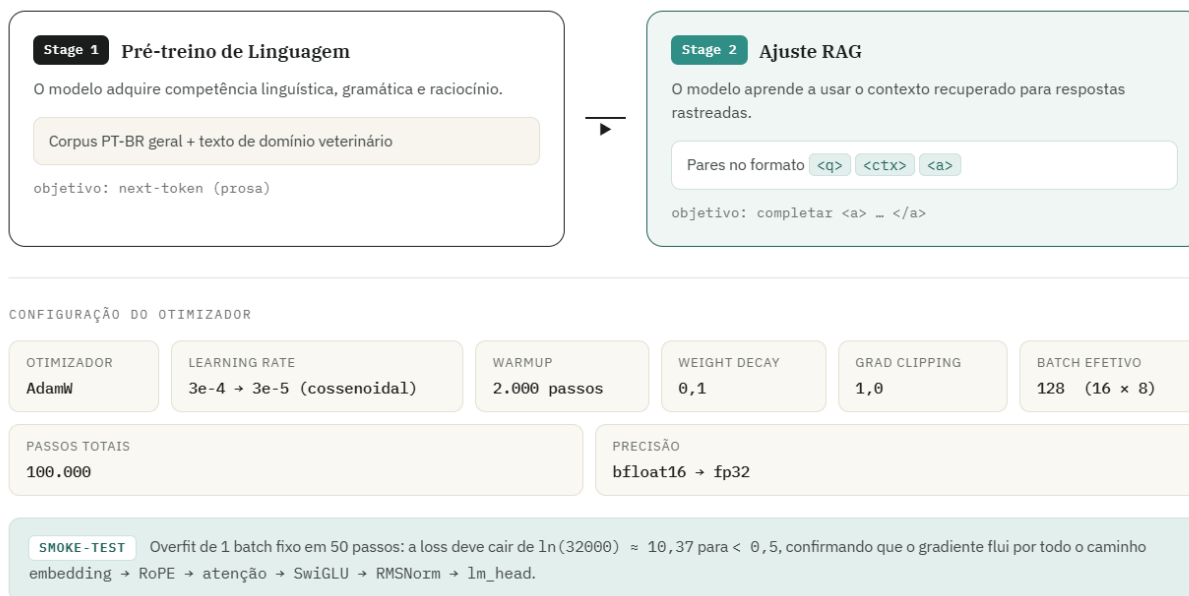
Figura 2 - Configuração de treinamento e requisitos computacionais da SophiaLLM V1.
